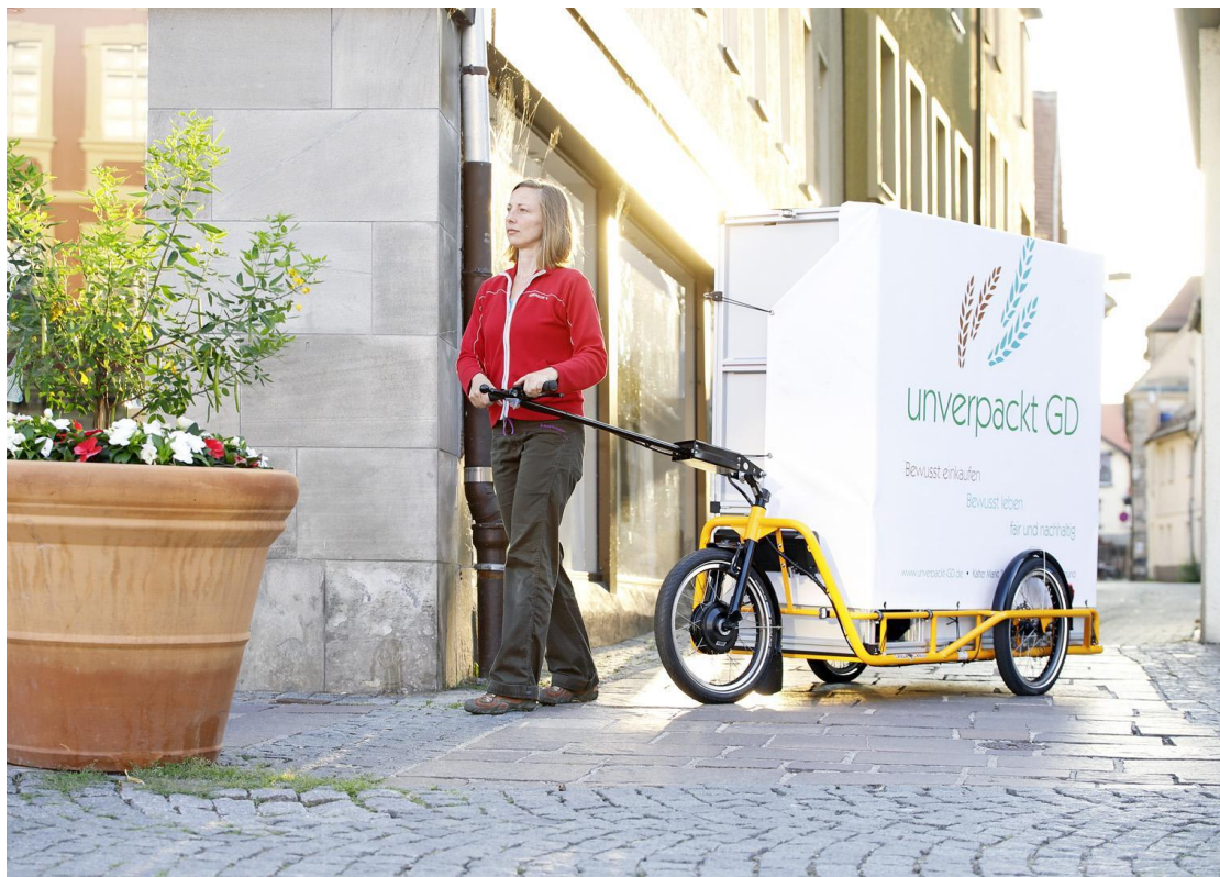
Carla Cargo-Lastenanhängen im „Handwagen“-Modus
