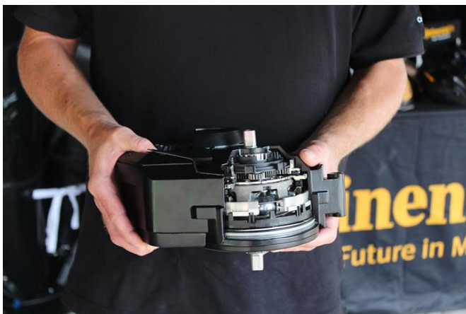
„48V Revolution“-Motor von Continental mit integriertem, stufenlosen Automatikgetriebe
