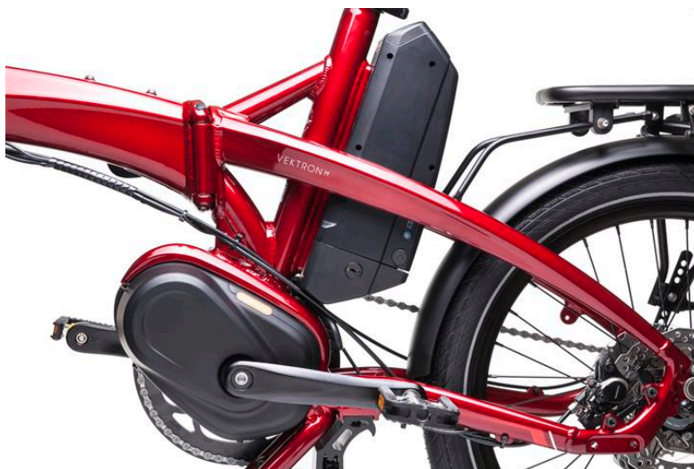
Bafang Max Drive Mittelmotor und 400Wh-Akku
