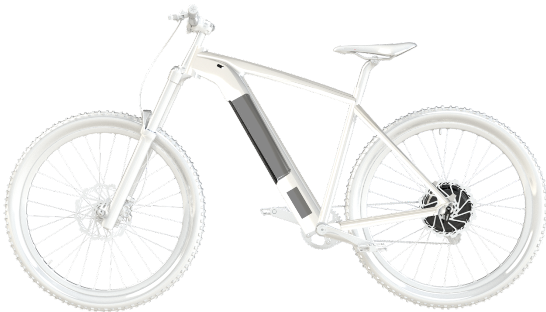
Visualisierung des H800 in einem 29-Zoll Laufrad, mit integriertem Unterrohr-Akku (Bafang F-Serie)
