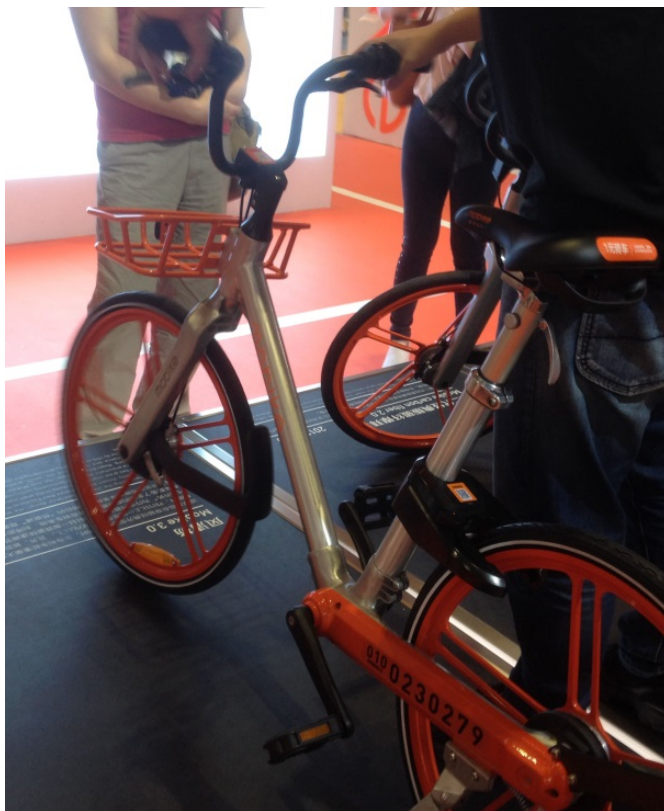
Abb.: Mobike – nichtelektrische Version eines Leihrades mit Kardan-Antrieb
