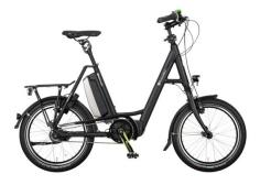
Das 20-Zoll-Rad mit den Modellnamen 7BEN besitzt einen gepulverten Kompakt-Rahmen mit tiefem Durchstieg und ist durch die kleinen Laufräder wie gemacht für flotte Touren durch die City. Bemerkenswert ist die Positionierung des Akkus: dieser sitzt gut aufgeräumt hinter dem Sitzrohr und sorgt so zusätzlich für einen tiefen Schwerpunkt.
