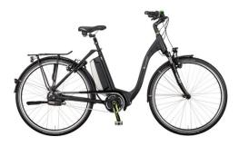
Die 28-Zoll-Räder mit den Modellnamen DR3I und 5NF rollen auf einem gepulverten Wave-Rahmen aus Aluminium 6061 mit Suntour-Federgabel. Besonderen Komfort bietet der große offene Durchstieg, der durch die Positionierung des Akkus hinter dem Sitzrohr erreicht wird.
